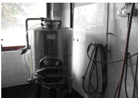
Slika 5 Vinifikator, kjer je potekala maceracija drozge modre frankinje (oktober 2009, Biotehniška fakulteta, Oddelek za živilstvo)
